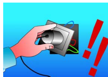
Ne pas laisser les prises descellées
