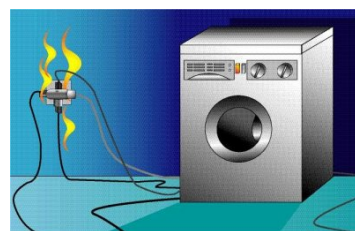
Ne pas utiliser de multiprises pour des équipements de forte puissance
