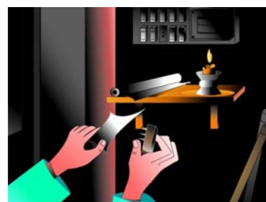
Ne pas remplacer un fusible par un fusible d'un calibre plus important
